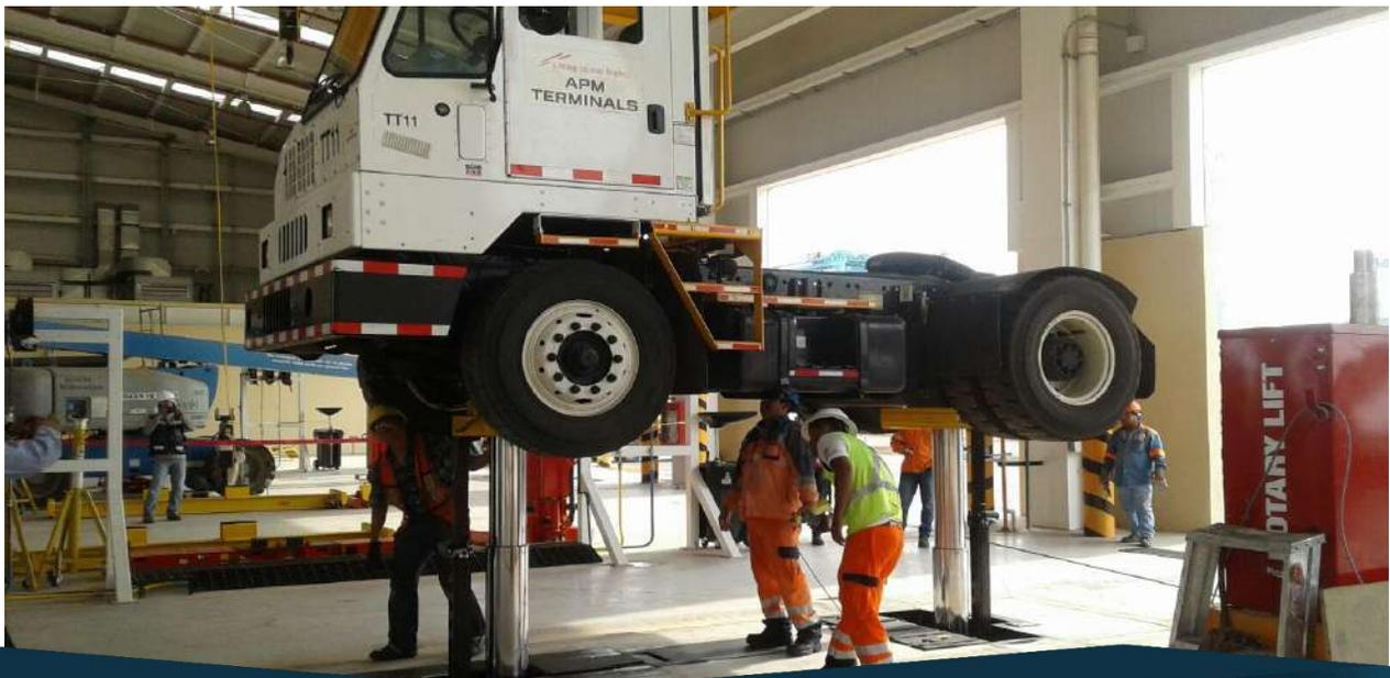
Instalación y colocación de equipos de elevación neumáticos rotary lift móviles y fijos, fueron colocados para que el mantenimiento de los vehículos de carga fuera más rápido y eficiente.
