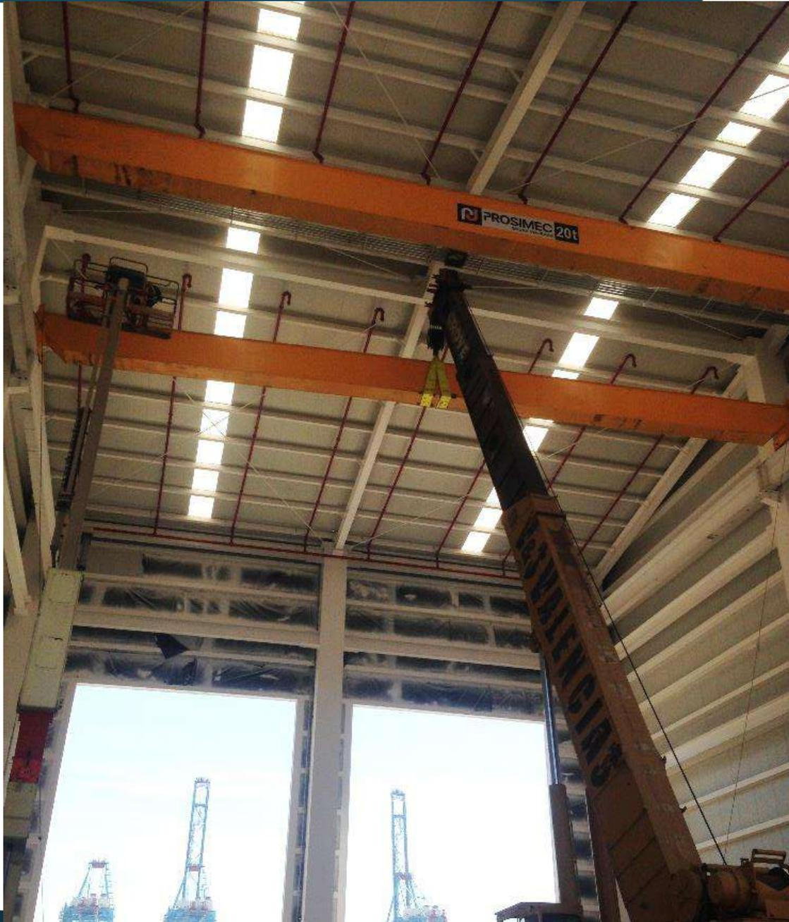
Se colocaron equipos grúas de izaje, capaz de levantar objetos de 16 y 20 toneladas, se realizaron las pruebas con carga suspendida.
